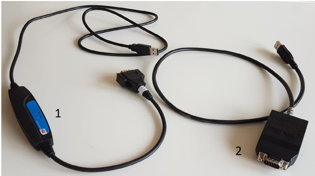
Figur 14. De två interfacen som användes vid utvecklingen av mjukvaran. 1) är Kvaser Leaf Light HS och 2) är PCAN-USB FD från PEAK.
