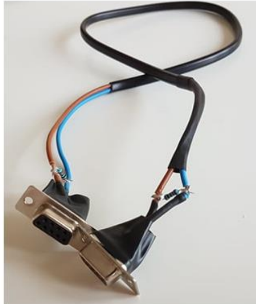
Figur 14. Överst på bilden syns schemat som användes för att kunna skapa en enkel CAN-buss. På D-Sub kontakten är pinne 2 CAN-low signalen och pinne 7 är CAN-high signalen, övriga pinnar behövde inte någon signal. Den nedre bilden visar kontakten som användes som CAN-buss. Fler noder kan kopplas upp på bussen mellan de båda 120 ohms motstånden, det viktiga är att 120 ohms motstånden finns i kabelns ände. Interfacen kopplades upp mellan var sin dator och var sin D-sub kontakt.
