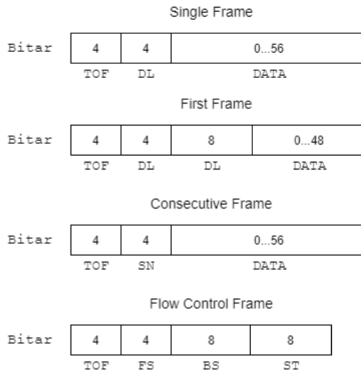
Figur 11. Single Frame har Type of Frame (TOF) värdet 0x0 som de 4 mest signifikanta bitarna och därefter 4 bitar som anger data length (DL) i bytes. Resterande 7 bytes används som datafält. First Frame har TOF värdet 0x1. Det finns 12 bitar (4+8) DL som anger hur många byte meddelandet är. Sex byte data kan skickas i ett FF. Consecutive Frame har TOF värdet 0x2 samt 4 bitar som anger sequence number (SN). SN har 4 bitar vilket innebär ett maximalt värde på 15. Om SN når 15 börjar det om från 0. För varje skickat meddelande ökar SN med 1. 7 byte data kan skickas i ett CF. Flow Control Frame har TOF värdet 0x3. Flow Status (FS) anger vilket stadie mottagarnoden befinner sig i, antingen kan noden befinna sig i stadiet redo att sända, vänta eller kö. Nästkommande byte Block Size (BS) anger hur många CS som ska skickas i samma block. Nästkommande byte Separation Time (ST) anger det minsta tidsintervallet som måste ha passerats innan nästa CF kan skickas. Ett ISO-TP meddelande är alltid 8 byte stort och icke använda bytes fylls på med utfyllnadsbytes med värdet 0xAA, 0x55 eller 0x00.
